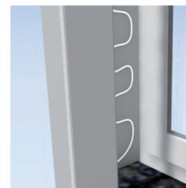
Anschließend wird die Abdeckleiste aufgebracht und das HYDROAKTIV Board wird mit dem HYDROAKTIV Dicht- & Klebstoff umlaufend abgedichtet.
